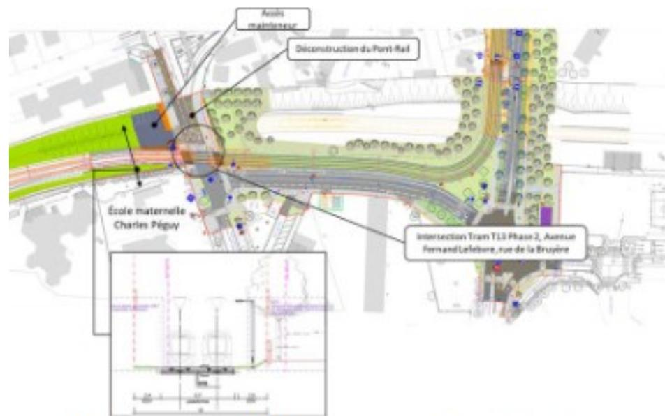
Figure 65 : Insertion en voie double en supprimant le Pont-Rail Lefèvre, source : PRO
