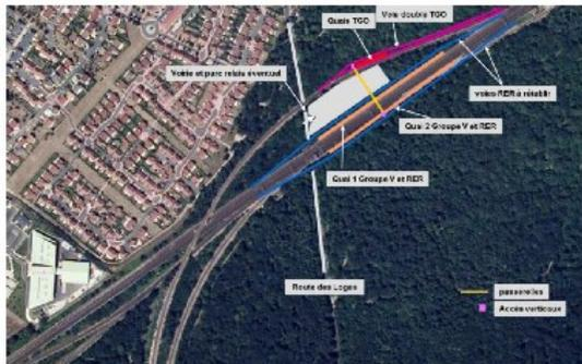
Schéma de principe de l'implantation d'une station entre le franchissement de la route des Loges et la jonction entre la Grande Ceinture et le groupe V (source : STIF, EGIS Rail, 2013)
