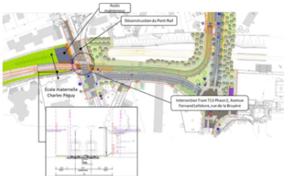
Figure 65 : Insertion en voie double en supprimant le Pont-Rail Lefebvre, source : PRO
